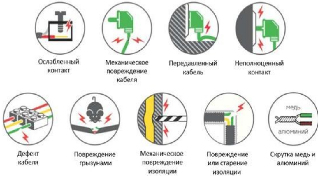
Рисунок 6. Возможные причины искрения в электропроводке
